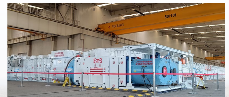
张煤机公司研发的世界首套 8 兆瓦超长运距智能刮板输送机联合试运转成功
